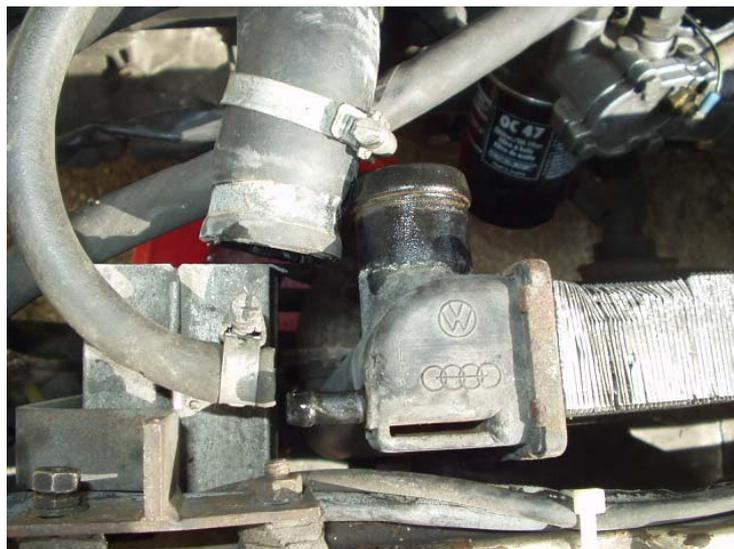
Sortir le radiateur puis démonter la buse support ventilateur et le thermocontact du ventilateur placé en bas à gauche de la boîte à eau.
