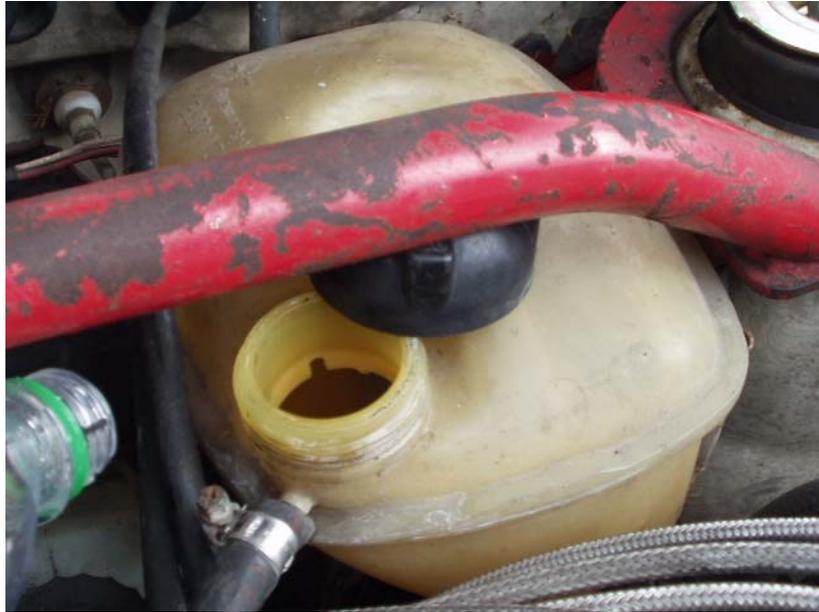
Laisser tourner le moteur jusqu'au déclenchement du ventilateur et faire de nouveau le niveau du liquide de refroidissement. Vérifier les éventuelles fuites.
