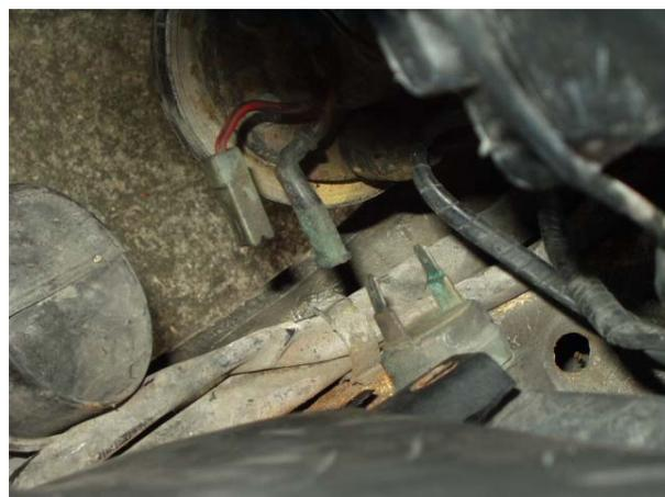
Lever la voiture côté droit et placer un saut sous la durite inférieure, démonter cette durite et laisser couler le liquide de refroidissement
